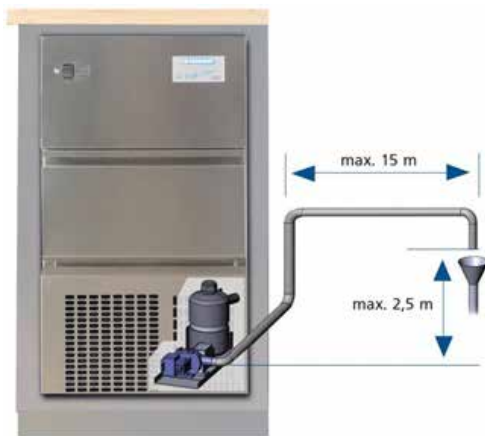
Abb. 6: Prinzip Schaubild einer vergleichbaren Anwendung mit optionaler Tauwasserpumpe.
